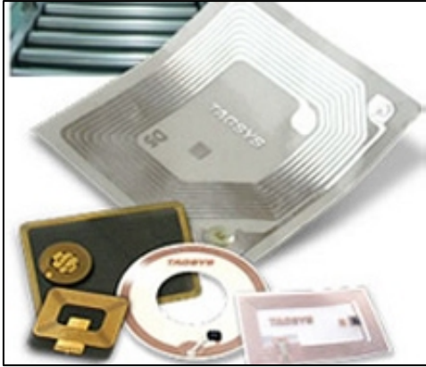
2. Dispositivo de RFID en forma de etiqueta:
