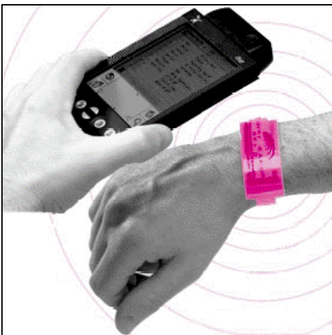
3. Dispositivo de RFID de pulsera y lector portátil:
